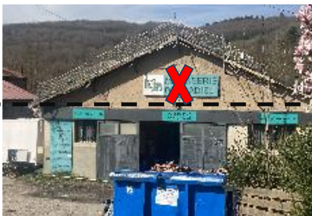
Exemple d'enseigne située trop en hauteur sur une façade, la limite de l'égout de toit n'est pas respectée.
